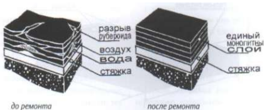
Рисунок 2. Изменения состояния рубероидного покрытия до и после ремонта с помощью УИВ.
